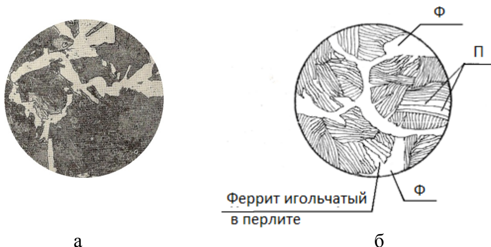
Рис. 6. А→П превращение: а – доэвтектоидная сталь 40 (0,40 % углерода). Травитель: 3% р-р азотной кислоты в спирте. Основа: Fe. Перегрев. Видманштеттова структура; б – схема изображения структуры Видманштеттова
